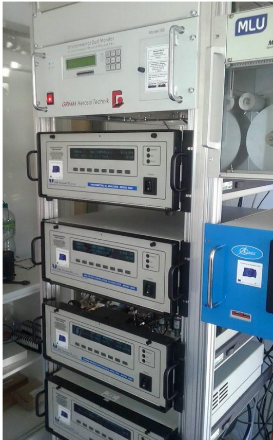
Fig.3 Analizerët brenda stacionit automatik monitorues dhe pajisja portabël
