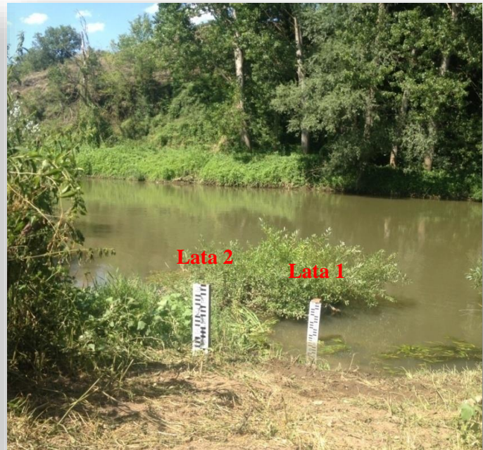
Foto 1/2/3. Stacioni hidrometrik në lumin Ibri në Leposaviç (modemi, nivelmatësit, paneli solar
